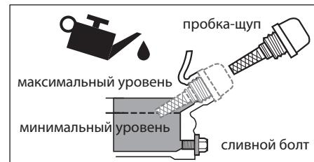
▶ проверьте наличие масла в картере двигателя, сняв крышку (с щупом) 6 горловины заправки масла. При наличии следов масла на щупе, проверьте уровень масла в картере: протрите щуп чистой сухой ветошью, установите щуп на место и снова выньте. Если уровень масла достаточен (между минимальной и максимальной метками щупа), доливать масло не следует.
