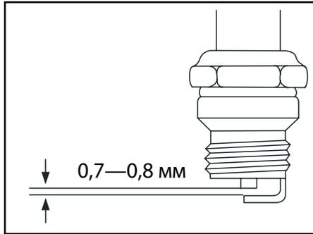
Зазор между электродами должен составлять 0,7-0,8 мм.
