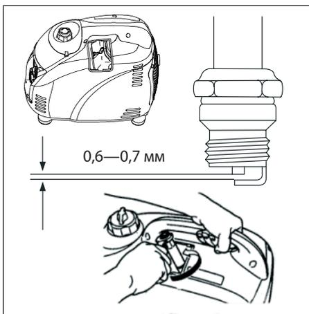
Зазор между электродами должен составлять 0,6-0,7 мм.
