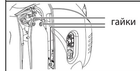
Снимите корпус 1 воздушного фильтра: **только для ЗИГ-1200** - поднимите пружинные фиксаторы; **кроме ЗИГ-1200** - отверните гайки крепления. Снимите крышку фильтра, извлеките фильтрующую
