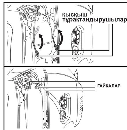
Ауа сүзгішінің 1 корпусын шешіңіз: тек қана **ЗИГ-1200 үшін** – қысқыш тұрақтандырушыларды шешіңіз; **ЗИГ-1200 басқасы** – бекіту гайкаларын бұрап алыңыз. Сүзгіш қақпағын шешіңіз, сүзетін элементті босатыңыз және оның ластануын сырттай бақылау арқылы қараңыз.
