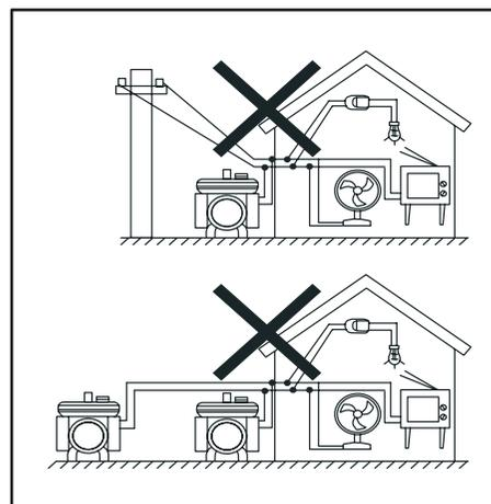
Подключение необходимо выполнять **ТОЛЬКО** через коммутационное устройство (например, двухполюсный переключатель), исключающее одновременное подключение к нагрузке обоих источников.
