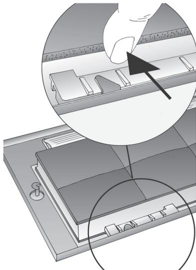
3. Установите рамку фильтра (см. «Снятие и установка жировулавливающего фильтра»).
