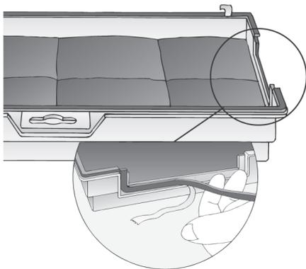
5. Вставьте угольный фильтр сзади, откиньте его вверх и зафиксируйте в середине барашковой гайкой. Если прокладка была удалена, снова установите ее.
