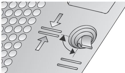
2. Нажмите на стопорную пружину и снимите рамку фильтра.
