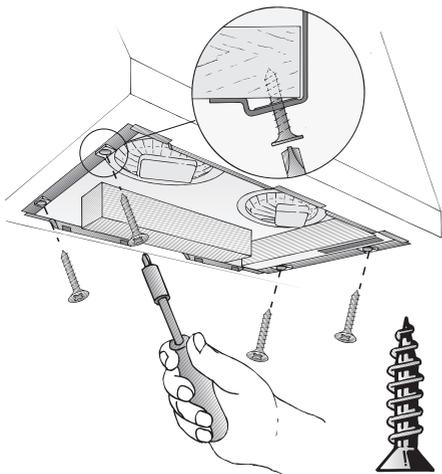
5. Установите **решетку фильтра** и закрепите ее (см. инструкцию по эксплуатации).
