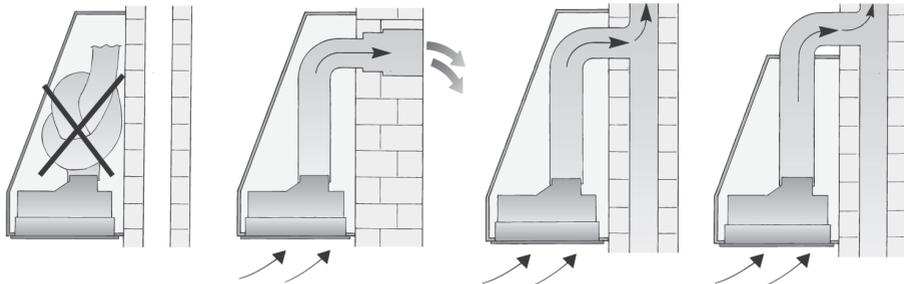
Отводимый воздух подается вверх через вентиляционную шахту или непосредственно через наружную стену за пределы помещения.
