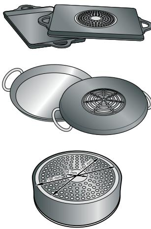
При использовании больших кастрюль и сковород со вставкой из ферромагнитных сплавов меньшего диаметра нагревание будет происходить только в ферромагнитной вставке, так что распределение тепла может оказаться неравномерным.
