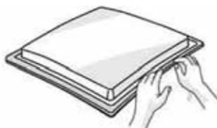
Установите варочную панель в выемку в столешнице, вырезанную по размерам, указанным в Руководстве.
