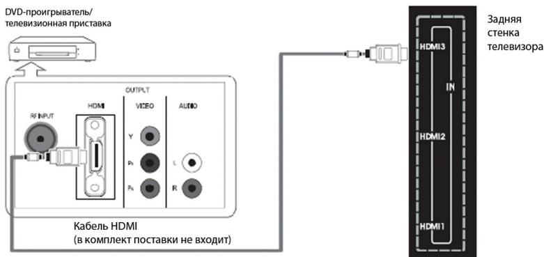
HDMI (High Definition Media Interface) представляет собой интерфейс нового поколения для передачи без сжатия многоканального цифрового звука и видео с помощью одного кабеля. Интерфейс HDMI отличается от DVI тем, что имеет меньший размер, передает многоканальный цифровой звук и имеет защиту от копирования HDCP (High Bandwidth Digital Copy Protection).
