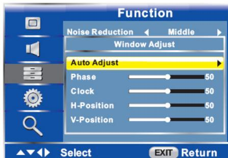
**Auto Adjust** – Автоподстройка. Выберите данный параметр, затем нажмите кнопку ► или ОК, чтобы выполнить автоподстройку положения изображения на экране в режиме ПК.
