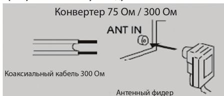
При использовании плоского кабеля 300 Ом для подключения к телевизору вам потребуется переходник-конвертер 300 Ом / 75 Ом.
