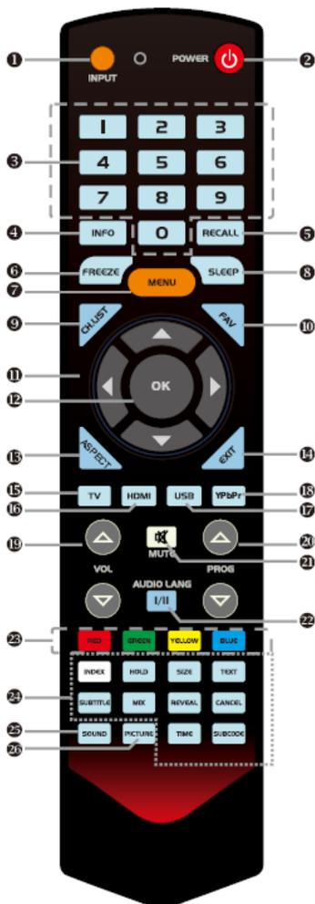
1. **INPUT** Кнопка выбора источника сигнала: TV, AV1, AV2, YPbPr, HDMI1, HDMI2, HDMI3, VGA, USB. В открывшемся меню выберите нужный источник и нажмите кнопку OK.
