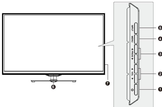
1. - Кнопка включения телевизора / перехода в режим ожидания
