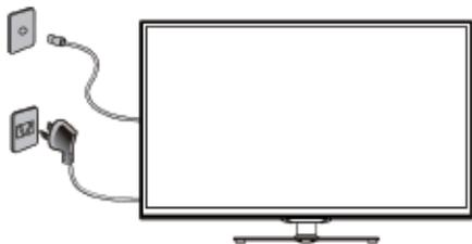
Подключите сетевой шнур питания к электрической розетке с характеристиками, указанными на маркировке телевизора.
