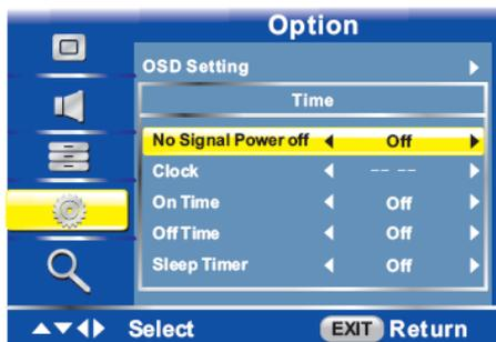
**No Signal Power off** – Автоматическое выключение при отсутствии сигнала. Выберите данный параметр и кнопками ►◀ установите значение On (Вкл), чтобы активировать функцию, или Off (Выкл), чтобы ее отключить. Когда функция активирована, телевизор выключается автоматически при отсутствии сигнала в течение 15 секунд в режиме VGA и 5 минут в остальных режимах.
