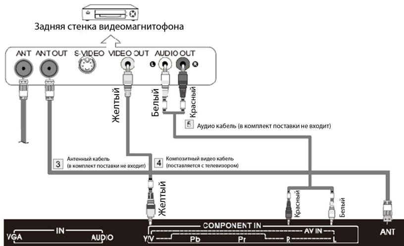
Конфигурация задней стенки видеомэагнитофона может быть различной. При подключении цвета штекеров соединительных кабелей должны совпадать с цветами разъемов, к которым они подключаются.
