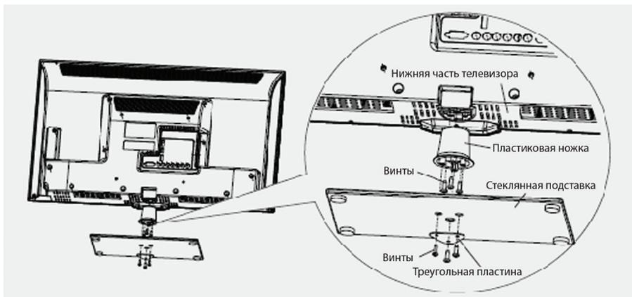
Прикрепите пластиковую ножку к нижней части телевизора с помощью трех винтов.
