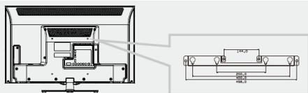
1. После того как вы сняли подставку, вкрутите 2 монтажных винта М6х8 (и/ или М6х18) (в комплект поставки не входят) в соответствующие монтажные отверстия на задней стенке телевизора (см. рисунок).
