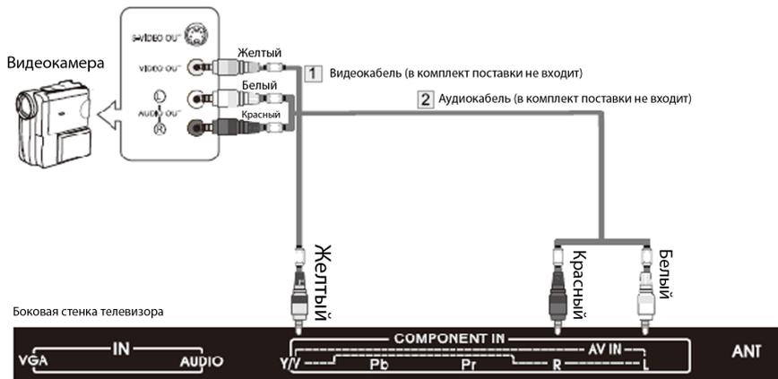
Конфигурация задней стенки видеокамеры может быть различной. При подключении цвета штекеров соединительных кабелей должны совпадать с цветами разъемов, к которым они подключаются.
