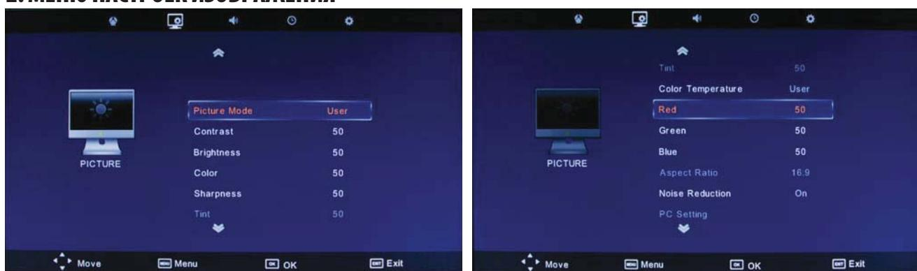
**Picture Mode** – Режим изображения. Выбрав один из режимов изображения: Standard (Стандартный), Dynamic (Динамический), Mild (Мягкий), вы можете одновременно отрегулировать яркость, контрастность, насыщенность и резкость изображения. Если вы установите режим User (Пользовательский), то сможете самостоятельно настроить параметры изображения самостоятельно. Вы также можете выбрать режим изображения, нажимая кнопку PICTURE.
