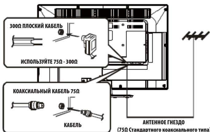
Сопротивление антенного входа телевизора – 75 Ом. МВ/ДМВ коаксиальный кабель может быть подключен напрямую к антенному гнезду, в то время как при использовании плоского кабеля 300 Ом для подключения к телевизору вам потребуется конвертер 300 Ом / 75 Ом.
