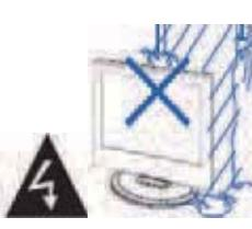
Не используйте телевизор вблизи воды, например, рядом с раковиной, мойкой или стиральной машиной, во влажном подвале, вблизи бассейна и т. д. После транспортировки в условиях низкой температуры перед включением телевизора дайте выдержку около часа при комнатной температуре, не включайте телевизор сразу, так как это приведет к образованию конденсата, что может вызвать пожар, поражение электрическим током или другие последствия.
