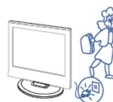
Для дополнительной защиты данного телевизора при грозовой погоде или когда не планируется его использование в течение длительного времени, отключите телевизор от розетки питания и отсоедините антенный кабель. Это предотвратит повреждение телевизора от молнии или из-за перепадов напряжения.
