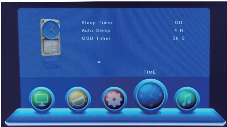
**Sleep Timer** – Время перехода телевизора в режим ожидания. Установите временной интервал, через который телевизор должен будет выключиться, для этого выберите нужное значение в минутах из списка: 10 min, 20 min, 30 min, 60 min, 90 min, 120 min, 180 min, 240 min или off (функция отключена).
