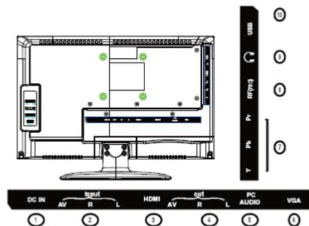
1. **DC IN** Разъем для подключения кабеля питания
