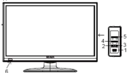
1. **STANDBY** - Кнопка включения телевизора / перехода в режим ожидания
