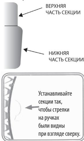
Перед тем, как наполнять секции продуктами, убедитесь, что секции выровнены правильно. Установите их друг на друга рядом с местом, где вы подготавливаете продукты для сушки. Имейте в виду, узкая сторона секции должна быть сверху, стрелки на ручках секций должны быть видны при взгляде сверху (см. рис.). Если секции будут установлены неправильно, это ухудшит результаты сушки.
