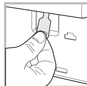
5. установите на место переднюю панель, проверив перед ее прикреплением к машине, чтобы крюки вошли в соответствующие петли.
