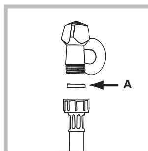
1. Підключіти живлячий трубопровід, прикрутивши його до крану холодної води за допомогою штуцера з газовою різьбою 3/4 (див. малюнок). Перед підключенням спустіть воду, доки вона не стане прозорою.
