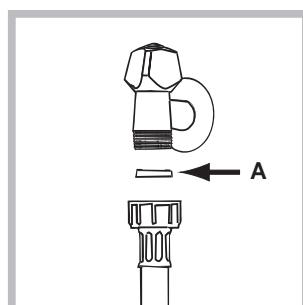
1. Вставьте прокладку А в конец заливного шланга и наверните его на вывод водопровода холодной воды с резьбовым отверстием 3/4 дюйма (см. рис.). Перед подсоединением откройте водопроводный кран и дайте стечь грязной воде.
