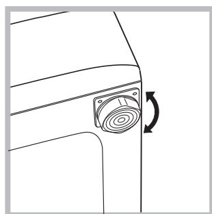
Належне вирівнювання надає стабільність машині та запобігає вібрації, шуму та пересуванню під час роботи. При встановленні машини на килимовому покрівлі або килимі відрегулюйте ніжки таким чином, щоб залишити під пральною машину достатній простір для вентиляції.
