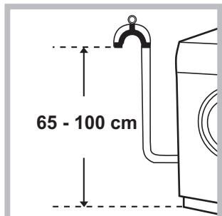
Подсоедините сливной шланг, не сгибая его, к сливному трубопроводу или к настенному сливу, расположенному на высоте 65 – 100 см от пола.
