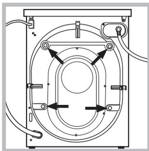
2. Снимите 4 винта, предохраняющие машину в процессе перевозки, и распорки, расположенные в задней части машины (см. схему).
