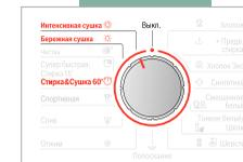
По умолчанию установлен режим сушки **FF** 1. В этом режиме время сушки автоматически регулируется в зависимости от объёма загрузки для обеспечения степени сушки, при которой бельё можно аккуратно сложить и убрать в шкаф (так называемая «Сушка в шкаф»). Вы можете изменить режим сушки на **FF** 2 для обеспечения более интенсивного результата сушки или для сушки по времени. Время сушки задаётся клавишей **FF** **Сушка**, чтобы узнать или выбрать продолжительность сушки. → с. 8: **Таблица сушки**
