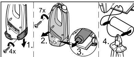
→ Apparaat mag alleen geopend worden voor de verwijdering van de accu.
