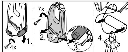
→ Cihaz, sadece akülerin tasfiye edilmesi için açılmalıdır.
