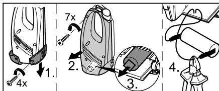
→ Gerät darf nur für die Entsorgung des Akkus geöffnet werden.
