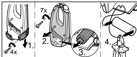
→ Maskinen för endast öppnas för att avlägsna batteriet för avfallshantering.
