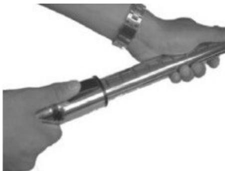
Отрегулируйте длину телескопической трубки. Для этого нажмите на фиксатор и вытяните трубку на нужную длину. Когда вы сделаете это, отпустите фиксатор, чтобы зафиксировать установленную длину трубки.
