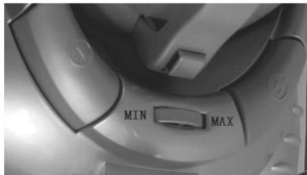
Мощность всасывания регулируется регулятором на корпусе пылесоса. Перед включением устройства в электросеть переведите регулятор мощности в положение минимальной мощности всасывания. Затем при работе для уборки твердых полов устанавливайте высокую мощность, для уборки ковров, ковров, матрасов и других текстильных покрытий – среднюю мощность, а для чистки портieres, книг, мебели и т.п. – низкую мощность.
