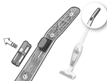
3a. Débrancher les câbles de connexion et retirer les batteries. Les batteries doivent être retirées avant que l'appareil ne soit mis au rebut.
