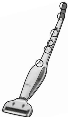
1. Mettre en marche Unirapido pour décharger complètement les batteries et enlever l'UniRapido du support de charge. Dévisser les 11 vis (2 d'entre elles sont situées sous le bouton de déverrouillage du bac).
