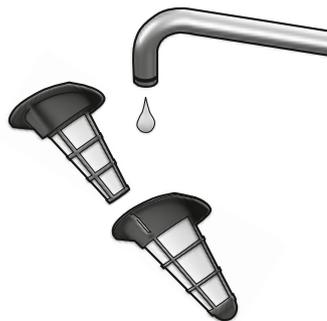
**4. Haal de filters uit elkaar.** Schud ze uit of spoel ze apart uit met warm water. Zorg dat de filters droog zijn voordat u ze in de omgekeerde volgorde terugplaatst.
