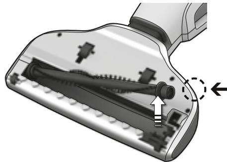
1. Appuyer sur le bouton de déverrouillage de la brosse rotative. La trappe d'accès est partiellement libérée et la brosse rotative peut être alors retirée.
