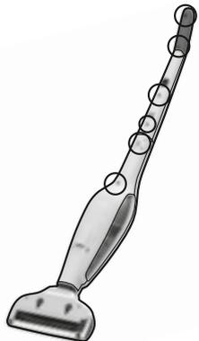
1. Kør batterierne flade, og fjern UniRapido fra ladestationen. Løsn de 11 skruer (2 af dem er skjult under udløserknappen).
