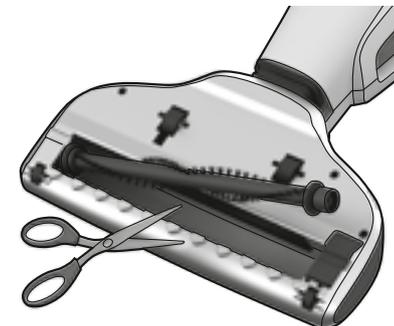
2. Retirer les cheveux et les fils à l'aide d'une paire de ciseaux manipulée avec précaution. Remonter la brosse rotative et s'assurer qu'elle est bien en place dans ses rails de guidage, et qu'elle peut tourner librement. Refermer la trappe d'accès.
