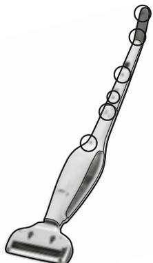
1. Kör så att batterierna tar slut och koppla loss UniRapido från laddningsstationen. Lossa de elva skruvarna (två av dem finns under spärrknappen).
