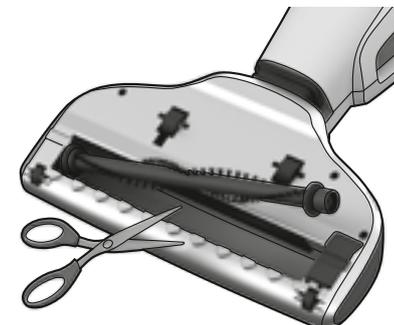
2. **Vlasy či nitě opatrně odstraňte ostrým předmětem..** Vraťte válcový kartáč na místo a zkontrolujte, že zapadá do drážek a může se volně otáčet. Vraťte kryt na místo.
