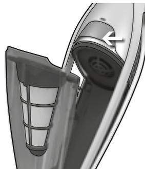
**1. Déverrouiller complètement le bac à poussière** en appuyant sur le bouton de déverrouillage.
