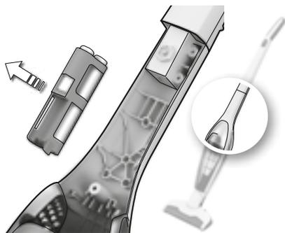
3b. Débrancher les câbles de connexion et retirer les batteries. Les batteries doivent être retirées avant que l'appareil ne soit mis au rebut.
