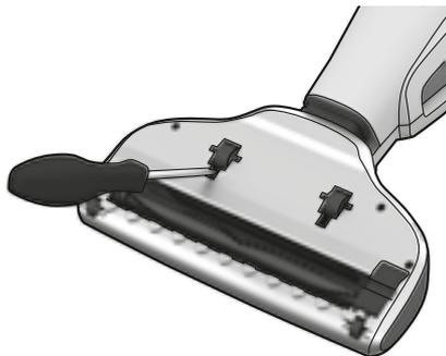
1. Dacă roțile trebuie curățate, îndepărtați-le cu atenție, utilizând o șurubelniță mică.
