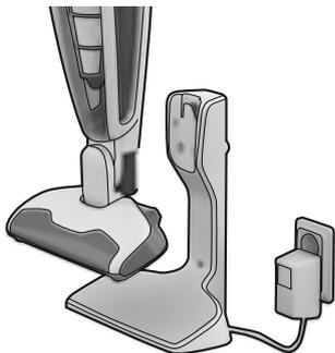
1. Plaats de UniRapido in het oplaadstation. **Zorg dat de UniRapido is uitgeschakeld als u deze in het oplaadstation plaatst.**
