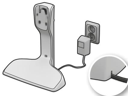
**1. Plaats het oplaadstation in de buurt van een stopcontact** (ver verwijderd van warmtebronnen, rechtstreeks zonlicht of natte gedeelten). Steek de adapter in het stopcontact en sluit deze aan op het oplaadstation
