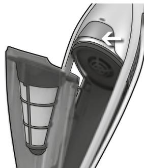
**1. Presione el botón de bloqueo para** extraer completamente el depósito de polvo.
