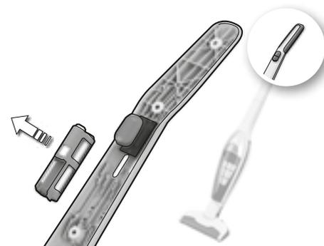
**3a.** Klik de verbindingkabels los en haal de batterijen uit het apparaat. De batterijen dienen te worden verwijderd voordat het apparaat wordt afgedankt.
