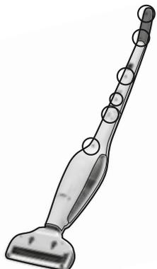
1. Baterie zcela vybijte a vysavač UniRapido odpojte od nabíjecí stanice. Uvolněte všech 11 šroubů (2 z nich jsou umístěny pod tlačítkem pro uvolnění).
