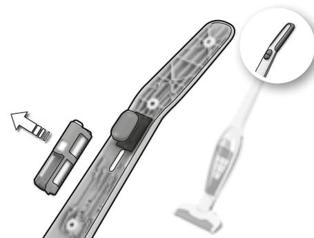
3. Odspojite spojene kablove i podignite baterije.
