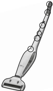
1. Descărcați complet bateriile și deconectați aparatul UniRapido de la unitatea de încărcare. Desfaceți cele 11 șuruburi (2 dintre ele sunt ascunse sub butonul de eliberare).
