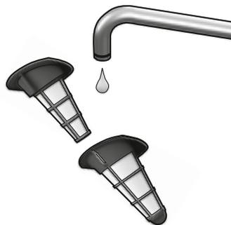
**4. Ta især filtren.** Skaka dem eller skölj dem i varmt vann. Se till att filtren är torra innan du sätter ihop dem igen.
