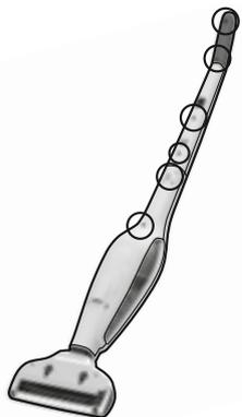
**1.** Gaste las pilas y desconecte la aspiradora UniRapido de la base de carga. Desenrosque los 11 tornillos (dos de ellos están ocultos debajo del botón de liberación).
