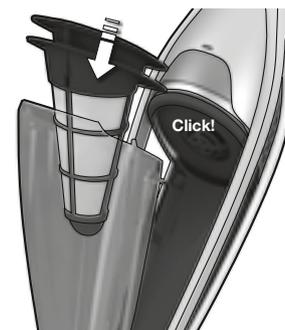
**5. Sätt tillbaka filtren och dammbehållaren i omvänd ordning.**
