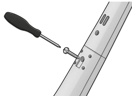
**2. Sätt fast handtaget** genom att skruva dit den medföljande låsskruven. Använd en skruvmejsel eller ett mynt.
