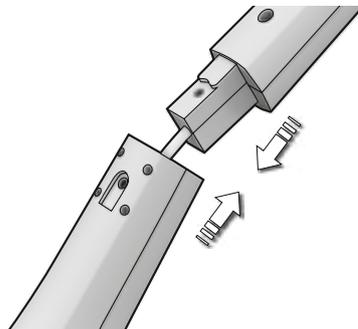
**1. Óvatosan csatlakoztassa a markolatot az alsó porszívótesthez.** Ügyeljen arra, hogy a kábel ne csípődjön be.
