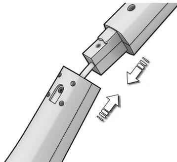
**1. Připojte rukojeť tak, že ji opatrně zasunete do spodní části těla vysavače.** Dávajte pozor, aby sa nedeformoval kábel.
