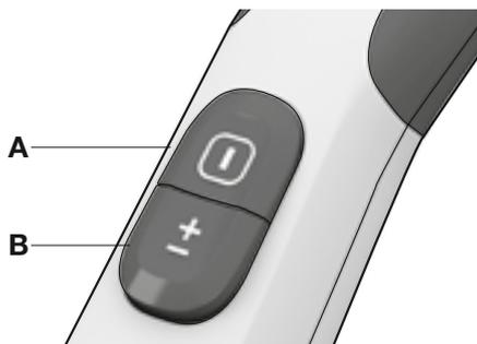
1 Pokrenite UniRapido pritiskom na tipku Uključeno/Isključeno
