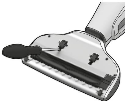
1. Si un nettoyage des roues s'avère nécessaire, les retirer avec précaution à l'aide d'un petit tournevis.
