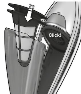
**5. Remettre les filtres et le bac à poussière en place** dans l'ordre inverse du démontage.
