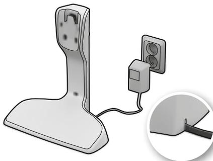
**1. Amplasați unitatea de încărcare în apropierea prizei** (la distanță de surse de căldură, de lumina directă a soarelui sau de locuri cu umiditate). Introduceți adaptorul în priză și conectați-l la unitatea de încărcare.
