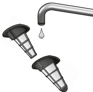
**4. Skil filtrene.** Ryst dem rene, og skyl dem for sig med varmt vand. Sørg for, at filtrene er tørre, inden de samles i omvendt rækkefølge.
