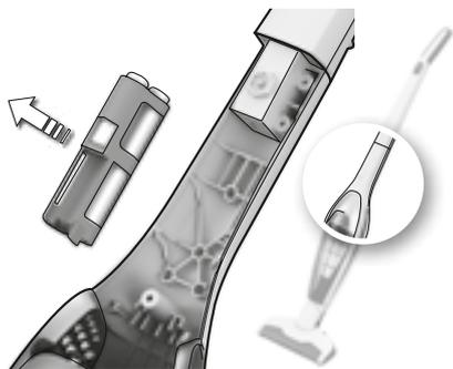
Batterier skal fjernes fra apparatet, inden det kasseres.
