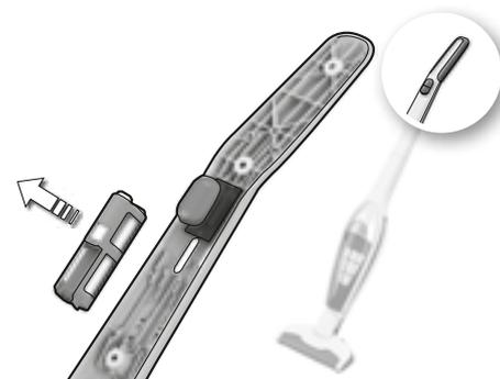
**3a.** Desconecte los cables de conexión y saque las baterías. Se deben quitar las pilas del aparato antes de desecharlo.
