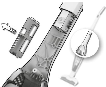
**3b.** Klik de verbindingkabels los en haal de batterijen uit het apparaat. De batterijen dienen te worden verwijderd voordat het apparaat wordt afgedankt.
