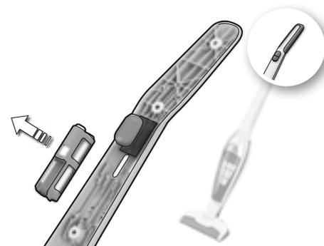
**3α.** Αποσυνδέστε τα συνδεδεμένα καλώδια και αφαιρέστε τις μπαταρίες. Πριν απορρίψετε τη συσκευή, πρέπει να αφαιρέσετε τις μπαταρίες.
