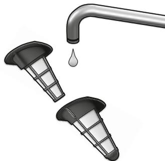
**4. Separati filtrele. Scuturați-le până se curăță sau clătiți-le separat cu apă caldă. Asigurați-vă că filtrele sunt uscate înainte de a fi montate la loc, în ordine inversă.**
