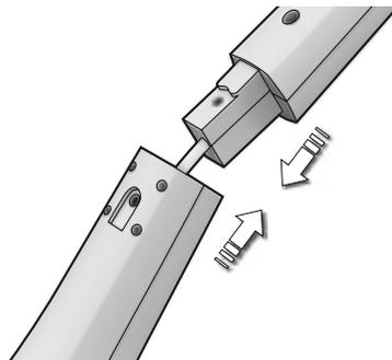
**1. Montați mânerul introducându-l cu atenție în partea inferioară a corpului.** Cablul nu trebuie să se blocheze.
