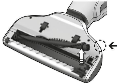
1. Tryk på udløserknappen til børsten. Det hængslede dæksel bliver en smule løst, og børsterullen kan fjernes.
