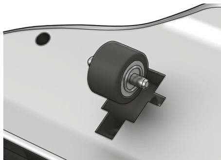
**2. Αφαιρέστε τα αντικείμενα που μπορεί να έχουν μπλεχτεί στους άξονες των τροχών.** Επανασυναρμολογήστε τους τροχούς πιέζοντάς τους μέσα στους οδηγούς τους.
