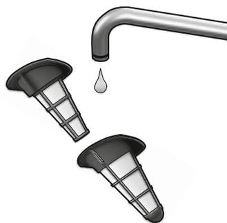
4. Oddělte filtry. Vyklepte je nebo každý zvlášť propláchněte teplou vodou. Před opětovným vložením filtry řádně vysušte.
