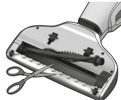
2. Brug forsigtigt et skarpt objekt til at fjerne hår eller tråde. Udsift børsteruller, og sørg for, at den passer i styreskinne og kan dreje frit. Monter det hængslede dæksel igen.
