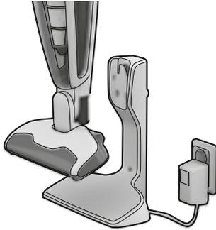
1. Coloque la aspiradora UniRapido en la base de carga. **Asegúrese siempre de que la aspiradora UniRapido está apagada cuando la coloque en la base de carga.**
