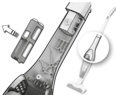
**3β.** Αποσυνδέστε τα συνδεδεμένα καλώδια και αφαιρέστε τις μπαταρίες. Πριν απορρίψετε τη συσκευή, πρέπει να αφαιρέσετε τις μπαταρίες.
