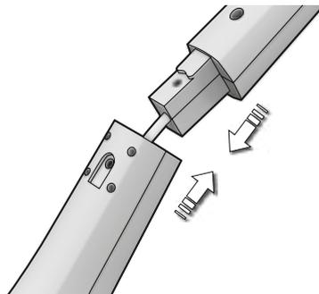
**1. Bevestig de greep door deze voorzichtig in het hoofdonderdeel te schuiven.** Zorg ervoor dat de kabel niet klem komt te zitten
