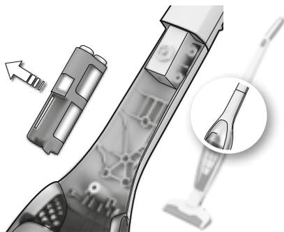
**3b.** Desconecte los cables de conexión y saque las baterías. Se deben quitar las pilas del aparato antes de desecharlo.
