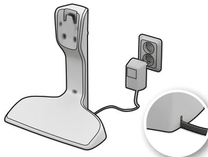
**1. Positionner le support de charge à proximité d'une prise secteur** (à bonne distance de toute source de chaleur, des endroits humides ou d'une exposition directe au soleil). Brancher l'adaptateur au secteur puis le connecter au support charge.
