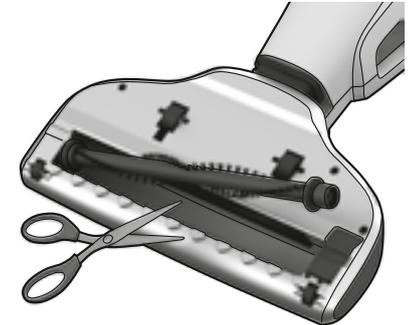
2. Utilice con cuidado un objeto afilado para retirar los pelos o los hilos. Vuelva a colocar el cepillo de rodillo y asegúrese de que se ajusta a sus guías y de que puede girar sin problemas. Vuelva a colocar la cubierta.
