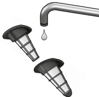
**4. Odvojite filtre.** Protresite ih ili properite odvojeno u toploj vodi. Provjerite jesu li filteri suhi prije nego ih ponovno sastavite obratnim redoslijedom.
