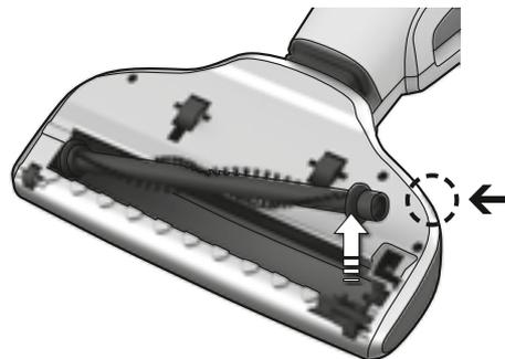
1. Stiskněte tlačítko pro uvolnění válcového kartáče. Kryt se lehce uvolní a kartáč bude možné vyjmout.
