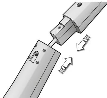
**1. Para ajustar el asa, insértela cuidadosamente en la carcasa principal inferior.** Asegúrese de que el cable no se atasca.
