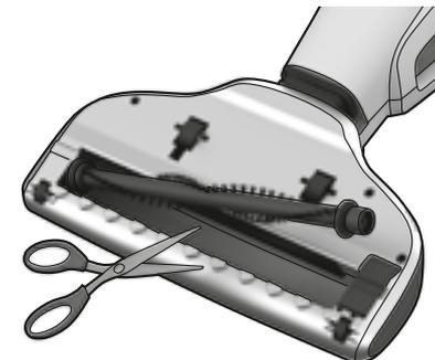
2. **Utilizați cu atenție un obiect ascuțit pentru a îndepărta părul sau firele.** Puneți la loc ruloul cu perii și asigurați-vă că intră în șinele de ghidaj și că se poate roti liber. Puneți la loc capacul.
