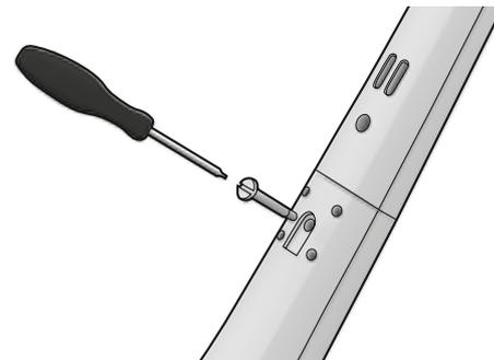
**2. Bevestig de handgreep** door de meegeleverde borgschroef vast te draaien. Gebruik een schroevendraaier of een munt.
