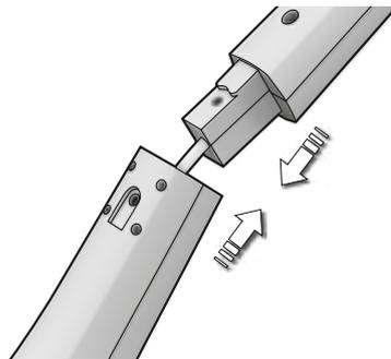
**1. Montér håndtaget ved forsigtigt at sætte det på den nederste hoveddel.** Pas på, at ledningen ikke sætter sig fast.
