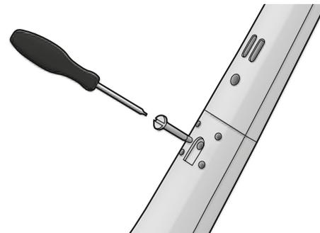
**2. Zajistěte rukojeť** dotažením dodaného upevňovacího šroubu. K dotažení použijte šroubovák nebo minci.
