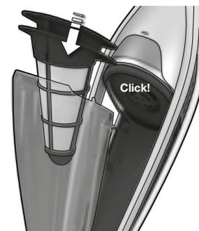
**5. A műveletek fordított sorrendű elvégzésével helyezze vissza a szűrőket, és nyomja vissza a helyére a portartályt.**
