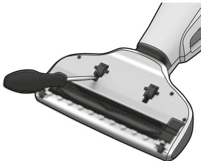
1. Ako treba očistiti kotačiće, pažljivo ih uklonite malim odvijačem.
