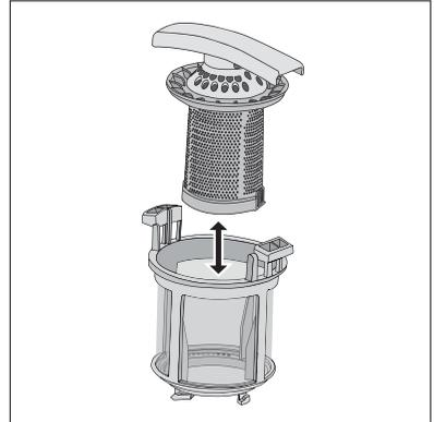
7. Setzen Sie den Filter (B) wieder in die ursprüngliche Position ein. Vergewissern Sie sich, dass er korrekt in den beiden Führungen (C) einrastet.
