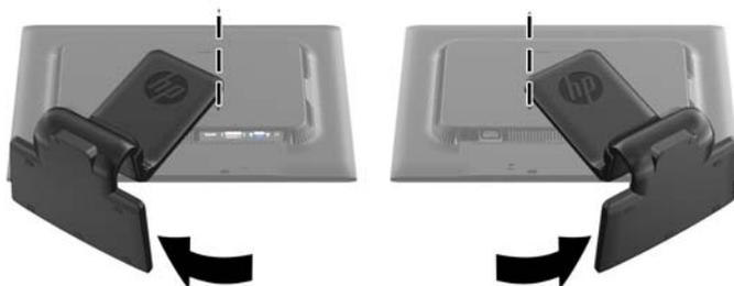
4. Поверните основание монитора вверх (1), затем потяните назад (2), чтобы извлечь выступы подставки из отверстий в мониторе.
