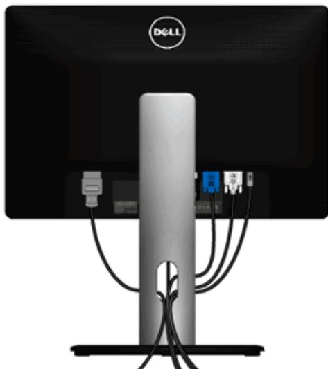
После подключения всех необходимых кабелей к монитору и ПК (см. [Подключение монитора](#) для подключения кабелей) воспользуйтесь отверстием для прокладки кабелей, как показано выше.
