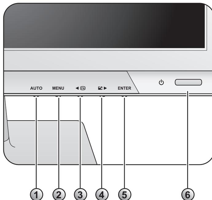
1. Кнопка **AUTO**- автоматическая установка положения по вертикали, положения по горизонтали и частоты тактового сигнала пикселей.
