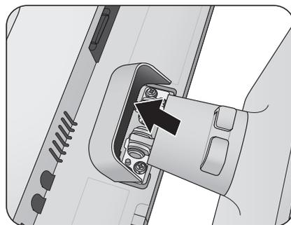
С помощью крестовой отвертки выверните винты, которыми подставка крепится к монитору. Рекомендуем использовать отвертку с магнитной головкой, чтобы не потерять винты.
