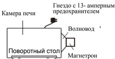
В СВЧ печи электрическая энергия превращается в микроволновую за счет трубки магнетрона.
