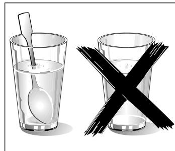
При разогревании жидкости возможно запаздывание закипания. В этом случае температура закипания достигается без образования в жидкости характерных пузырьков. Даже при небольшом встряхивании посуды горячая жидкость может неожиданно сильно закипеть или начать разбрызгиваться. Опасность ожога!
