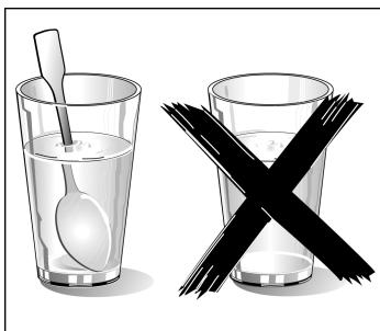
Sıvılar ısınma esnasında buharlaşma nedeniyle azalabilir. Yani tipik buharlaşma kabarcıkları olmadan kaynama noktasına ulaşılacaktır. Kabin sadece biraz sarsılması durumunda bile sıcak sıvı aniden taşabilir veya sıçrayabilir. Yanma tehlikesi!
