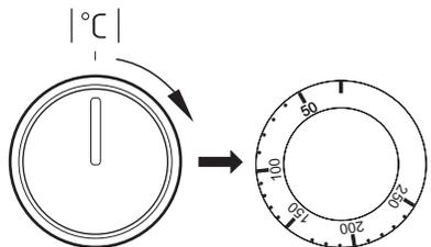
Beim Ausschalten des Geräts sind beide Schalter in die „●“ / „0“ Position zu drehen.
