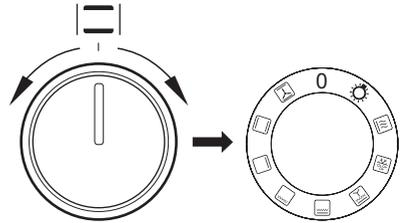
und des Temperaturreglers – die Wahl der gewünschten Backofentemperatur erfolgt durch Drehen auf den entsprechenden Temperaturwert.
