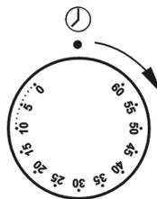
Минутный таймер не управляет работой плиты. Это просто устройство звуковой сигнализации, напоминающее о необходимости выполнения кратковременных кулинарных действий. Диапазон времени составляет от 0 до 60 минут.
