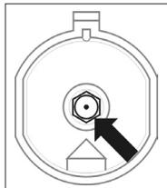
*Замена инжектора – инжектор вывинтить при помощи торцевого ключа с насадкой 7 и заменить на новый, соответствующую типу газа (см. таблицу).*
