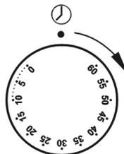
Минутный таймер не управляет работой плиты. Это просто устройство звуковой сигнализации, напоминающее о необходимости выполнения кратковременных кулинарных действий. Диапазон времени составляет от 0 до 60 минут.
