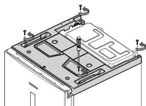
2. Зніміть пластикову кришку та від'єднайте кабель, що під'єднаний до неї. Знявши кришку, перевірте деталі для переустановлення дверцят.
