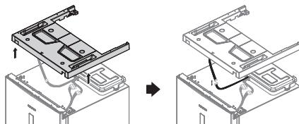
**Внимание** При снятии крышки следите за тем, чтобы не повредить электрические провода.
