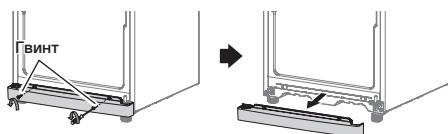
6. Відкрутіть 3 болти, що фіксують завісі, а потім відкрутіть 3 болти з лівого нижнього боку біля передньої ніжки, куди буде встановлюватися знята завіса.
