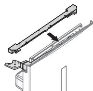
15. Снимите крышку ручки и вывинтите винты, а затем отсоедините заглушки и переместите ручку с левой на правую сторону дверцы (обязательно установите снятые заглушки на левую сторону).
