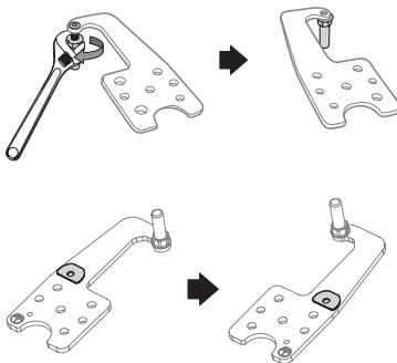
13. Установите на место петлю на дверце холодильника, повторив в обратном порядке действия шага 11. Используйте левостороннюю крышку петли, которая находится под снятой пластиковой крышкой (шаг 2), и извлеките прокладку. После установки на место петли, провода и крышки петли выполните перестановку с правой стороны на левую.
