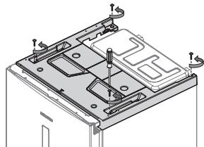
2. Снимите пластиковую крышку и отсоедините провода, подсоединененные к ней. Сняв крышку, проверьте детали для перестановки дверцы.
