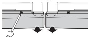
3. Відкрутіть гвинти з обох виробів, а після встановлення нижнього фіксатора поверніть їх на місце.
