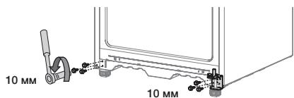
7. Вначале отсоедините шпиндель петли с помощью шестигранного ключа. Вывинтите болт, чтобы снять подставку, и переставьте шпиндель и подставку на другую сторону
