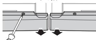
3. Выкрутите винты из обоих изделий, а после установки нижнего фиксатора верните их на место.
