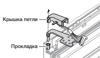
**Внимание** При снятии крышки петли следите за тем, чтобы не повредить электрические провода.
