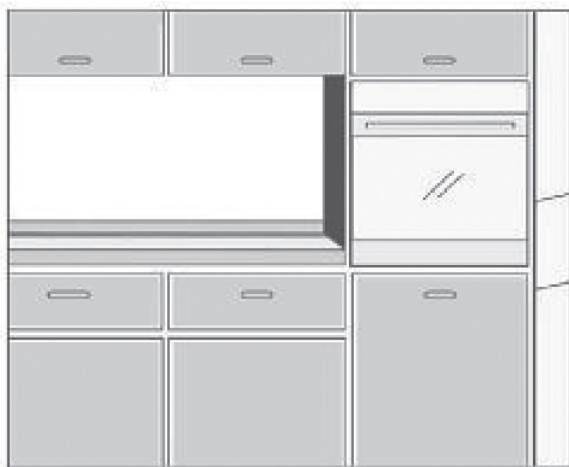
Монтаж духового шкафа в высокий шкаф
