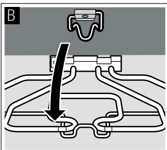
**3.** По окончании очистки установите нагревательный элемент гриля обратно в верхнее положение, придерживая его.
