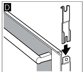
6. Установите защитную панель на место и закрепите её. Если винты защитной панели не вворачиваются, проверьте, правильно ли располагаются стёкла в держателе.
