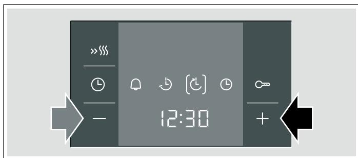
Через несколько секунд установка будет принята, духовой шкаф перейдёт в режим ожидания. На дисплей выводится время, к которому блюдо должно быть готово, символ  $\odot$  заключается в скобки. Символы  $\ominus$  и  $\odot$  гаснут. Когда духовой шкаф включится, символ  $\odot$  будет взят в скобки, и начнётся обратный отсчёт времени выполнения. Символ  $\odot$  гаснет.
