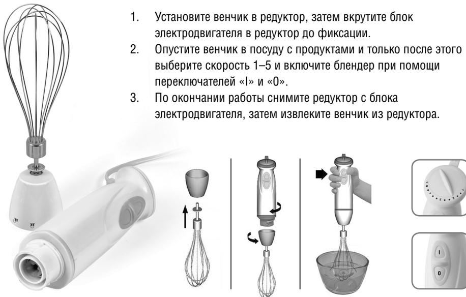
1. Установите венчик в редуктор, затем вкрутите блок электродвигателя в редуктор до фиксации.
