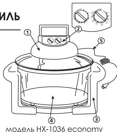
**КРЫШКА** - самая важная часть аэрогриля. С помощью рукояток времени и температуры Вы управляете прибором. В крышке расположены нагревательный элемент и вентилятор, подающий горячий воздух к приготавляемым в аэрогриле продуктам.
