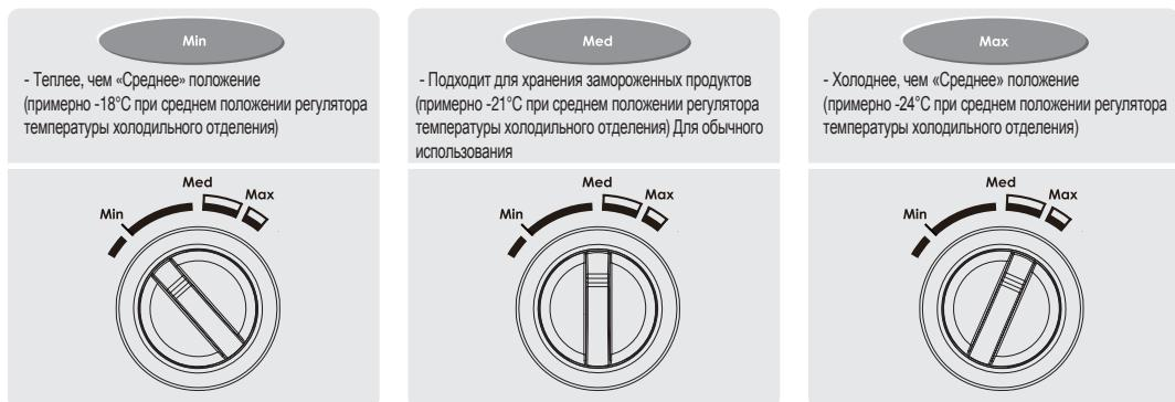
Функция заморозки может работать хуже, когда температура окружающего воздуха опускается ниже 5 градусов. Рекомендуется переместить устройство в другое помещение. Температура в холодильном отделении может изменяться от количества продуктов, места установки и тп.
