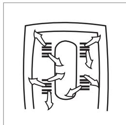
Не закрывайте вентиляционные отверстия. Не допускайте чрезмерного заполнения.
