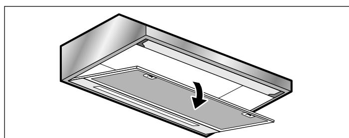
**3.** Установите решётку фильтра под наклоном и снимите её.
