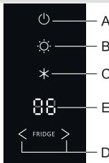
Функция **VitaLED** включается и выключается с помощью кнопки **B**. При включенном функции кнопка **B** подсвечивается. При включении функции **VitaLED** загорается оранжевая светодиодная подсветка контейнера для овощей и фруктов. В случае отключения электроэнергии функция **VitaLED** сбрасывается.
