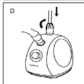
3. Закрепите телескопическую стойку, повернув фиксатор по часовой стрелке.
