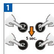
Stiskněte všechna 4 tlačítka a podržte po dobu 5 vteřin (při zapnutém přístroji). Všechna tlačítka 3krát blížejí: všechna množství jsou znova nastavena na původní hodnotu.
