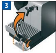
Otworzyć drzwiczki do schowka na rurkę do odkamieniania. Podłączyć rurkę do odkamieniania do złączki pary urządzenia.
