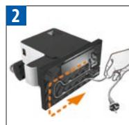
Vyjměte zásobník na vodu, odkapávací misku a zásobník na kapsle. Upravte délku kabelu tak, že ho vložíte do prostoru na kabel umístěný dole pod přístrojem.
