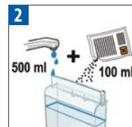
Vyprázdněte odkapávací misku a odpadní nádobu na kapsle. Naplňte zásobník na vodu 100 ml odvápněvacím prostředku od Nespresso a doplňte 500 ml vody.
