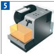
Umieścić po jednym pojemniku o objętości min. 1 litra pod otworem wylotu kawy i dyszą rurki do odkamieniania.
