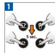
Wcisnąć wszystkie 4 przyciski na 5 sekund (gdy urządzenie jest włączone). Podświetlenia wszystkich przycisków mrugają 3 razy: wszystkie objętości są przywrócone do wartości początkowych.
