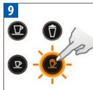
Ponownie naciśnąć przycisk Cappuccino. Cykl płukania przechodzi przez wylot kawy, rurkę do odkamieniania oraz taczkę ociekową, dopóki nie opróżni się zbiornik z wodą. Podświetlenia przycisków Cappuccino i Macchiato mrugają na przemian.
