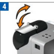
Wyjąć filiżankę. Podnieś i zamknij dźwignię w celu wyrzucenia kapsułki do zbiornika na zużyte kapsułki.
