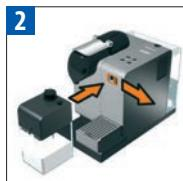
Zamknąć pojemnik na mleko. Otworzyć drzwiczki do łączki pary przesuwając je w prawo. Podłączyć System Rapid Cappuccino do urządzenia.
