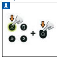
Przytrzymać przycisk Lungo i włączyć urządzenie.
