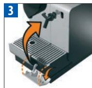
Otevřete dvířka prostoru pro uložení odvápněvacích hadiček. Zapojte odvápněvací hadičku do trysky na páru přístroje Nyissa le a vízkőmentesítő cső tárolóhelyének ajtaját. Dugja a vízkőmentesítő csővet a gép gőzölésre szolgáló csatlakozójába.
