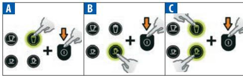
Przytrzymać i przytrzymać wskazane przyciski, włączyć urządzenie.
