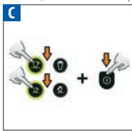
Przytrzymać jednocześnie przyciski Lungo i Espresso i włączyć urządzenie.
