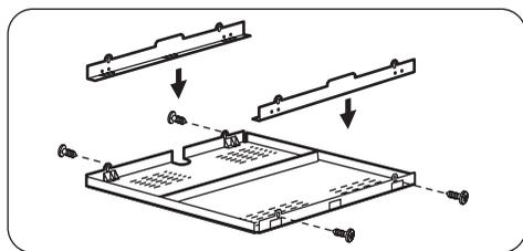
В случае использования защитного короба (дополнительная принадлежность<sup>1)</sup>), фронтальный 2-мм вентиляционный зазор и защита пола под прибором не являются обязательными.
