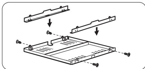
Якщо використовується захисний короб (додаткове приладдя<sup>1)</sup>), вентиляційний простір спереду (2 мм), а також захисне покриття безпосередньо під приладом не потрібні.
