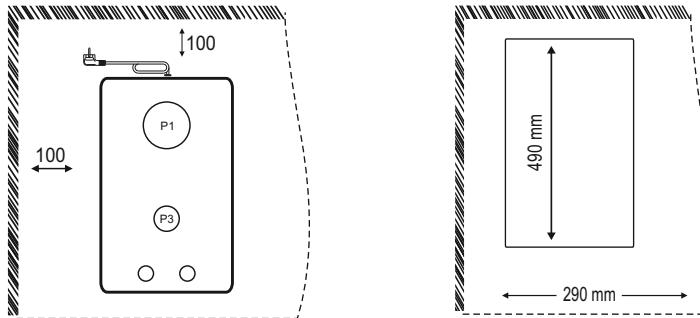
Внешние размеры, указанные цифрами, определяют стандартные размеры поверхности на столешница. После того, как столешница подготовлена, обратитесь в обслуживающий центр для установки поверхности. Позвоните в уполномоченный сервисный центр.
