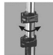
1. Послабте кріплення, висуньте трубку на потрібну довжину, затягніть кріплення.
