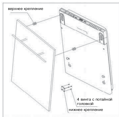
Рис. 4а. Установка декоративной панели.
