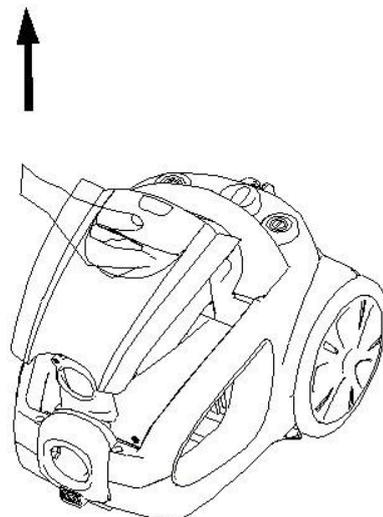
4. После очистки пылесборника, очистите воздушный фильтр, в случае необходимости. (см. раздел «Очистка воздушного фильтра» ниже). Затем промойте пылесборник холодной проточной водой и вытрите насухо.
