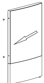
6. Вывинтите винты петли и снимите петлю, а затем поднимите дверцу и положите ее на мягкую поверхность, чтобы не поцарапать. Поместите петлю и винты в безопасное место.
