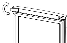
8. Поверните дверцу, вывинтите винт и переместите стопор на другую сторону. Затем надежно закрепите стопор винтом.
