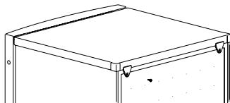
2. Для освобождения верхней крышки сдвиньте ее вперед. После этого сдвиньте небольшую пластиночку слева направо. Затем уберите верхнюю крышку в безопасное место, чтобы не поцарапать.
