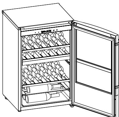
**Păstrați vinul la întuneric.** Ușa este din sticlă fumurie cu trei straturi, cu protecție UV, pentru a proteja vinul de lumină în cazul în care răcitorul este amplasat într-un spațiu luminos.
