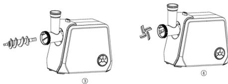
Вставьте шнек в камеру мясорубки длинным концом внутрь. Слегка поворачивайте шнек, чтобы зафиксировать его в корпусе мясорубки.
