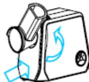
Удерживая камеру мясорубки, вставьте ее в отверстие для крепления на корпусе.
