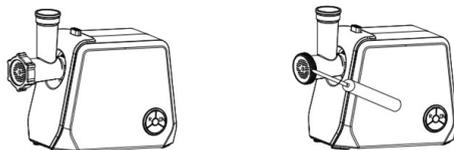
Если у вас не получается открутить прижимную гайку вручную, используйте для этого инструменты. Чтобы легко отделить решетку, поместите отвертку между решеткой и камерой мясорубки, а затем отодвиньте решетку отверткой.
