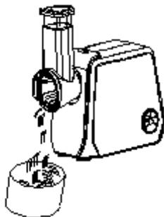
Нажмите кнопку ON/OFF . Толкателем аккуратно проталкивайте овощи в загрузочную горловину.
