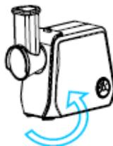
Поворачивайте камеру мясорубки против часовой стрелки, пока не услышите щелчок. Теперь камера мясорубки надежно прикреплена к ее корпусу. Слегка покачайте камеру мясорубки, чтобы убедиться, что она надежно держится.
