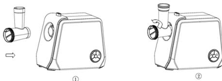
Удерживая камеру мясорубки, вставьте ее в отверстие для крепления на корпусе. Поворачивайте камеру мясорубки, пока не услышите щелчок. Теперь камера мясорубки надежно прикреплена к ее корпусу. Слегка покачайте камеру мясорубки, чтобы убедиться, что она надежно держится.
