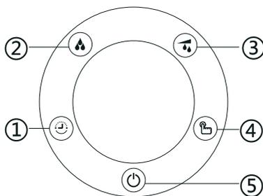
1. Кнопка установки времени автоматического выключения прибора
