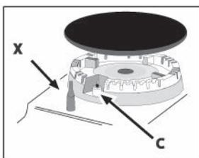
В моделях, имеющих устройство электронного зажигания\* (C), нажмите кнопку электронного зажигания, обозначенную символом
