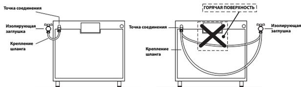
! Если хотя бы одно из приведенных выше требований не удастся выполнить, или, если плита должна устанавливаться по правилам, относящимся к бытовым приборам класса 2 подкласса 1 (установка между двумя шкафами), то согласно действующим стандартам для подключения газа должны использоваться только гибкие металлизированные трубы.
