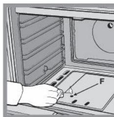
Чтобы зажечь горелку духовки, поднесите горящую спичку или зажигалку к отверстию «F» (см. *рис.*), нажмите и поверните рукоятку управления духовкой против часовой стрелки в положение Max.
