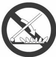
**Предупреждение!** Стеклопанель крышки плиты может треснуть от нагрева. Прежде чем закрыть крышку, обязательно выключите все горелки.\*
