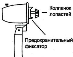
Наденьте заднюю решетку на стержень двигателя и закрепите фиксатором.
