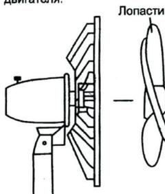
Закрутите колпачок на стержне, поворачивая против часовой стрелки.
