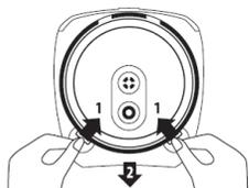
Нажмите на крепления по стрелкам «1», затем снимите крышку по стрелке «2». После этого проведите чистку крышки.
