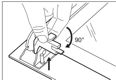
7. Сначала осторожно поднимите и выньте стеклянную панель.
