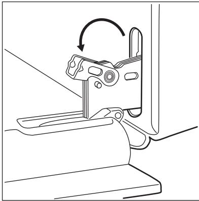
3. Закройте дверцята духової шафи до першого фіксованого положення (наполовину). Потягніть дверцята уперед, виймаючи їх із гнізд.
