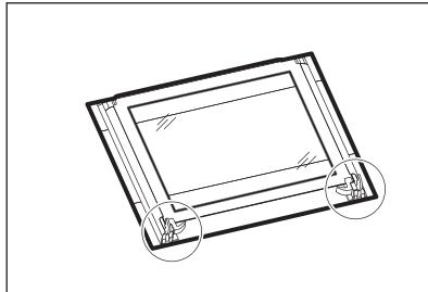
5. Вивільніть систему блокування для того, щоб витягнути внутрішню скляну панель.
